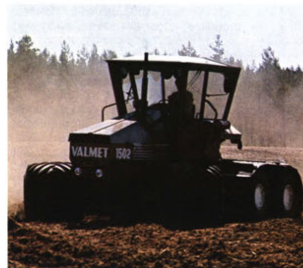
Traktorn i praktiskt bruk. Denna har specialbreda däck och används bl a vid torvhantering.
