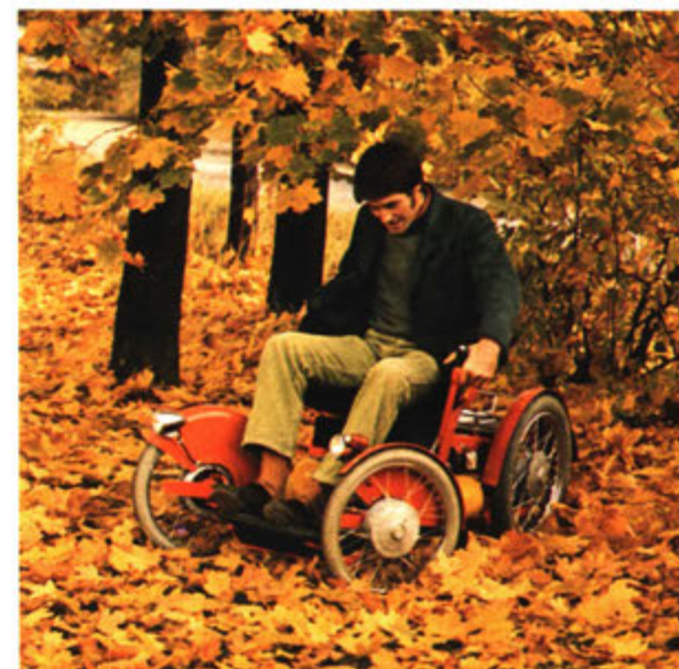
En rullstol måste vara anpassningsbar till många olika handikapp. Denna rullstol, med sin låga tyngdpunkt, har goda egenskaper speciellt för utomhusbruk.
