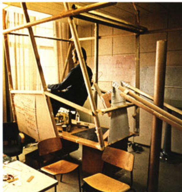
En enkel, fullskalig modell av kartongrör på ett bord räcker för att ge en uppfattning om förarens utrymmeskrav.
