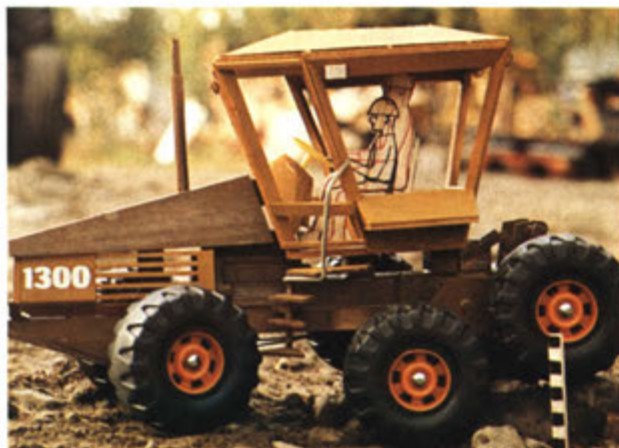
Vid utvecklingen av en traktorhytt utgår man från förarens behov av räckvidd och utrymme. Sits, reglage och synfält måste vara anpassade därefter. Modellen är i skala 1:10.
